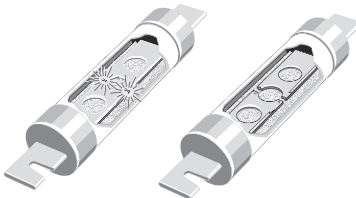
Fusible durante la falla
